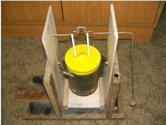
Figura 9: Motor Stirling terminado. Hay que notar que se ha añadido una segunda estructura de madera con el fin de evitar que el motor vibre mientras está operando.
