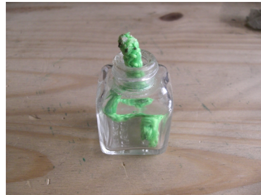
Figura 7: Mechero construido a partir de un envase pequeño de vidrio y un cordón.
