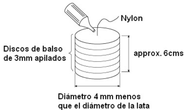
Figura 2: Esquema del pistón de desplazamiento. Imagen adaptada de la referencia [1].
