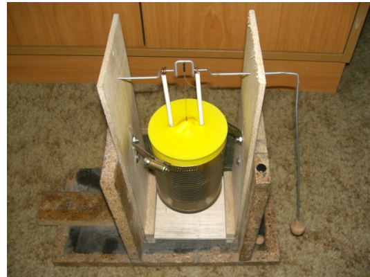
Figura 10: Motor Stirling terminado. Hay que notar que se ha añadido una segunda estructura de madera con el fin de evitar que el motor vibre mientras está operando.
