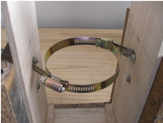
Figura 6: Forma en que se conectan las abrazaderas con el fin de sostener la lata.
